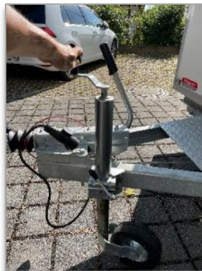
Bild 12: Rangierrad absenken, Befestigung Anhänger- kupplung feststellen
