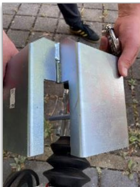
Bild 10: Schloss Diebstahl- sicherung öffnen und Vorrichtung abnehmen
