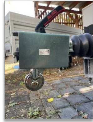
Bild 21 Diebstahlsicherung an der Anhängerkupplung anbringen
