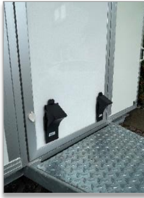
Bild 20: Spülmobil mit den Sicherungskeilen gegen wegrollen sichern.
