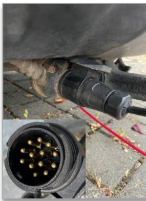
Bild 14: 13-poligen Elektrostecker am Fahrzeug befestigen
