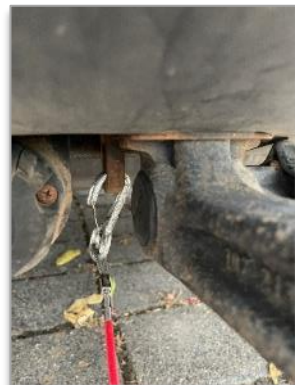
Bild 13: Karabinerhaken der Sicherheitsbremse am Fahrzeug einhängen
