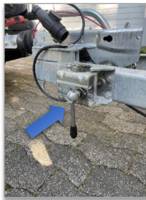
Bild 16: Halterung für Rangierrad wieder schließen und festschrauben
