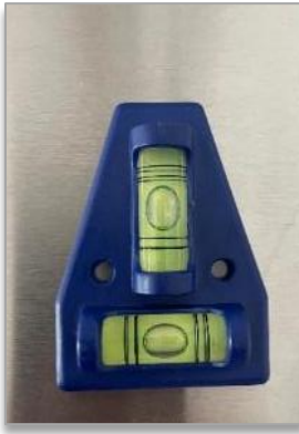
Bild 18: Wasserwaage im Spülmobil von Klett- halterung lösen und Anhängers ausrichten
