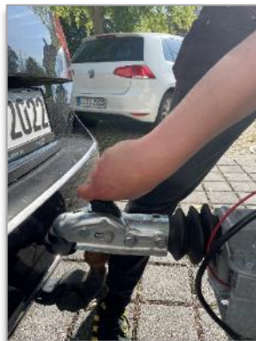
Bild 11: Anhängervorrichtung über Kupplung positionieren
