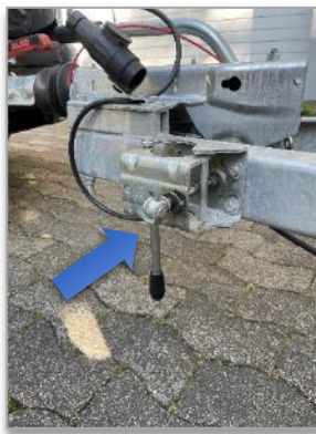
Bild 16: Halterung für Rangierrad wieder schließen und festschrauben
