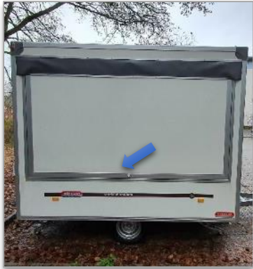
Bild 23: seitliche Thekenklappe, außen: Öffnen und schließen mit 4-Kantschlüssel
