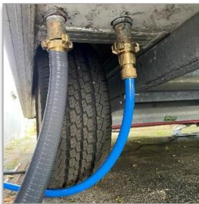
Bild 3: Trinkwasser- und Abwasseranschluss am Spülmobil
