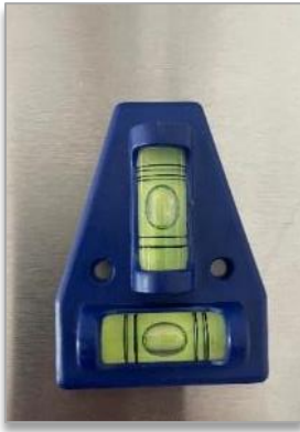
Bild 18: Wasserwaage im Spülmobil von Klett- halterung lösen und Anhänger ausrichten
