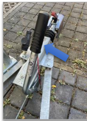
Bild 17: Wenn Zugfahrzeug gegen wegrollen gesichert ist – Feststellbremse Spülmobil lösen
