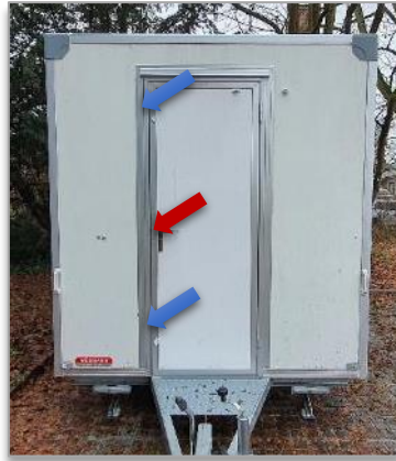
Bild 24: Eingangstür Blaue Pfeile: Öffnen und schließen mit 4-Kantschlüssel Roter Pfeil: Mit Spülmobil-Tür- schlüssel öffnen und schließen
