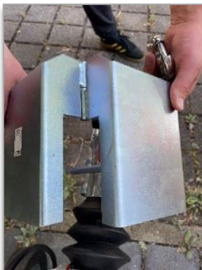
Bild 10: Schloss Diebstahl- sicherung öffnen und Vorrichtung abnehmen
