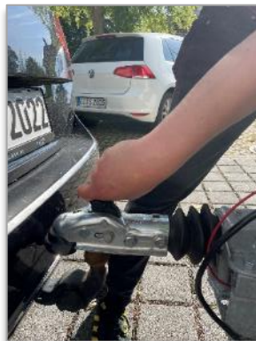
Bild 11: Anhängervorrichtung über Kupplung positionieren
