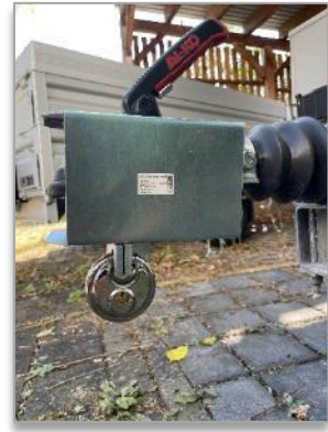
Bild 21 Diebstahlsicherung an der Anhängerkupplung anbringen
