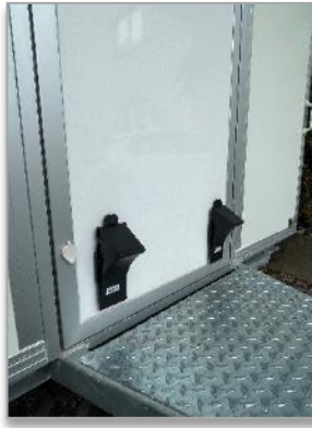
Bild 20: Spülmobil mit den Sicherungskeilen gegen wegrollen sichern.
