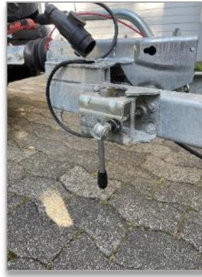
Bild 16: Halterung für Rangierrad wieder schließen und festschrauben
