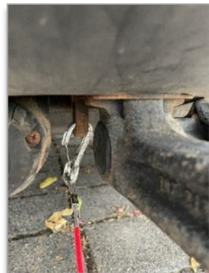
Bild 13: Karabinerhaken der Sicherheitsbremse am Fahrzeug einhängen
