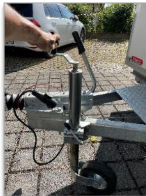
Bild 12: Rangierrad absenken, Befestigung Anhänger- kupplung feststellen
