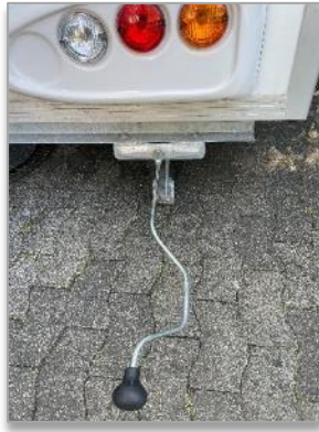
Bild 19: Alle vier Sicherungs- stützen mit der Hand- kurbel herunterlassen
