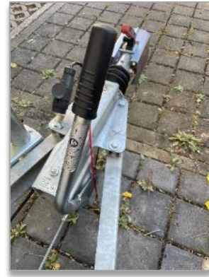
Bild 17: Wenn Zugfahrzeug gegen wegrollen gesichert ist – Feststellbremse Spülmobil lösen
