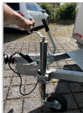
Bild 12: Rangierrad absenken, Befestigung Anhänger- kupplung feststellen
