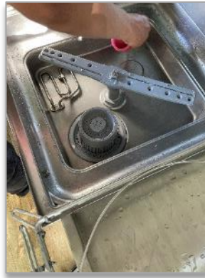
Bild 30: Ansicht Spülmaschine ohne Plastiksiebabdeckungen
