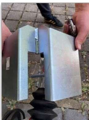
Bild 10: Schloss Diebstahl- sicherung öffnen und Vorrichtung abnehmen
