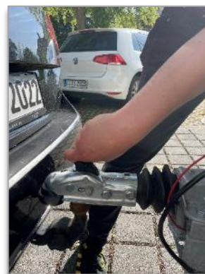
Bild 11: Anhängervorrichtung über Kupplung positionieren
