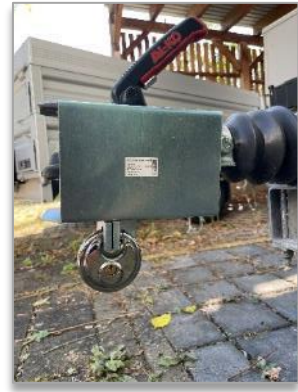
Bild 21 Diebstahlsicherung an der Anhängerkupplung anbringen
