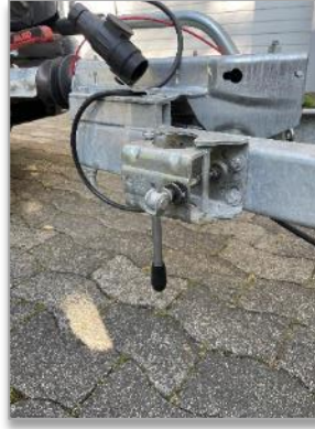
Bild 16: Halterung für Rangierrad wieder schließen und festschrauben
