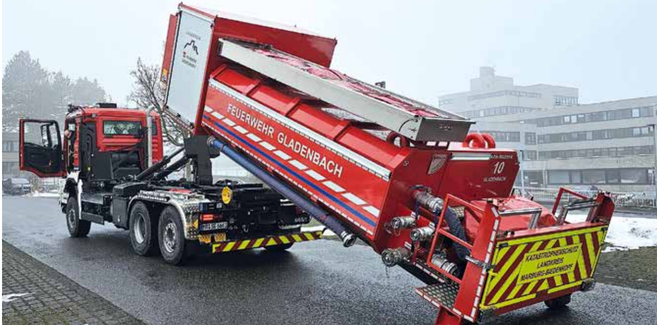
10.000 Liter passen in diesen Abrollbehälter. Sechs Stück davon sowie fünf Trägerfahrzeuge hat der Landkreis beschafft, zwei weitere Behälter waren bereits vorhanden. Damit ist die Versorgung mit Löschwasser, insbesondere bei Waldbränden, gesichert. (Foto: Landkreis)
